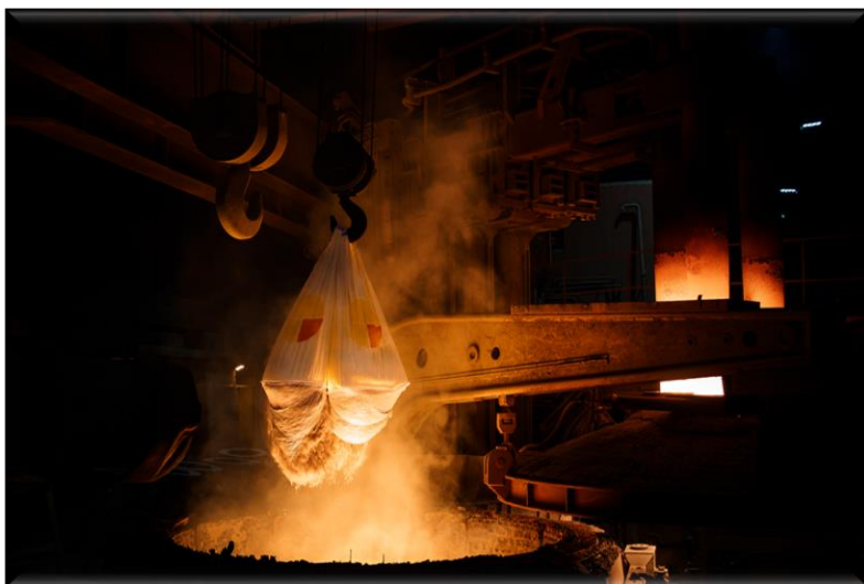
Foto: Tillsättning av kalk i ljusbågsugn, SMA Mineral
